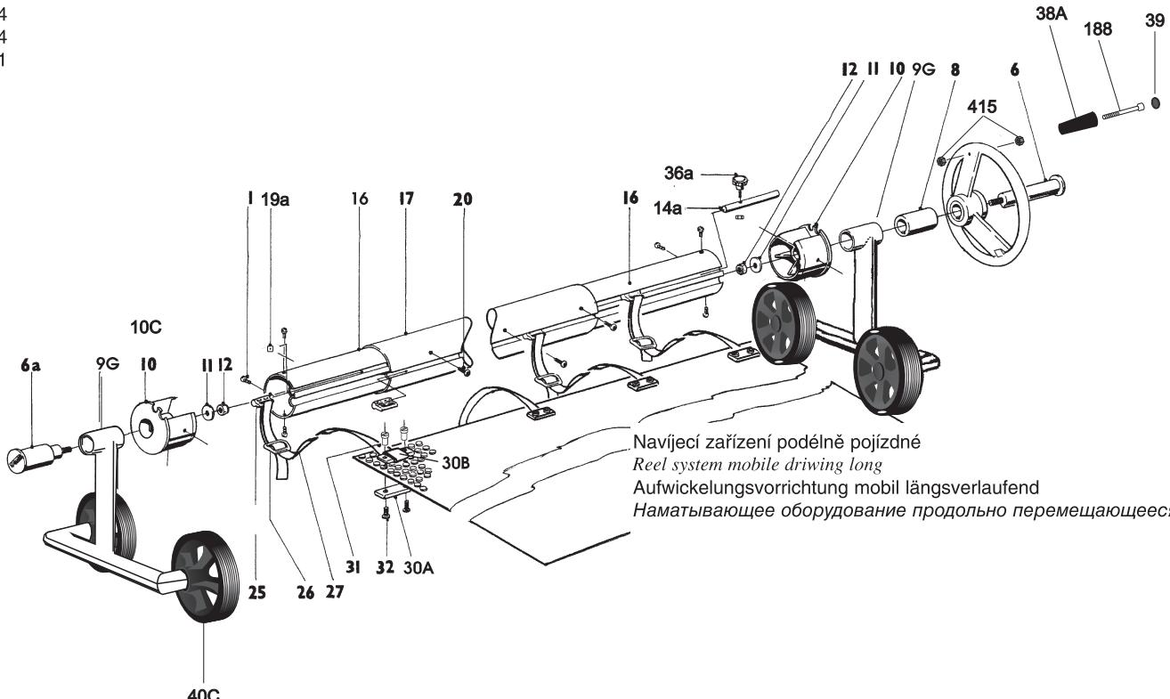
Navíjecí zařízení podélně pojízdné
