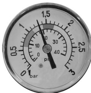
1,3 kg/cm 2 - 18,5 PSI: Questa pressione indica che è necessario procedere al LAVAGGIO.
