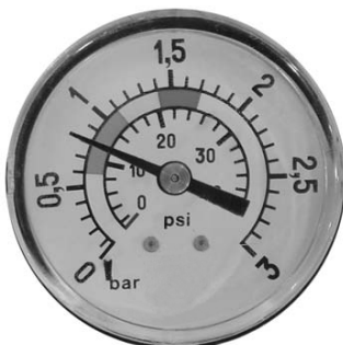
0,8 kg/cm 2 - 11,4 PSI: Normaldruck bei Beginn des Filtriervorganges.
