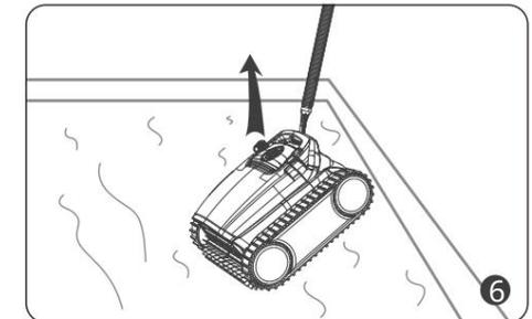
Ziehen Sie den Staubsauger mithilfe des mitgelieferten Hakens an der Stange an die Oberfläche.
