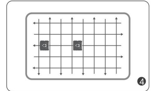
Der Staubsauger beginnt mit der Reinigung der Wände, des Bodens und der Wasserlinie gemäß Ihren Standardeinstellungen über die App.
