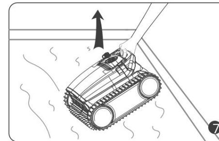
Um das Wasser im Inneren schnell ablaufen zu lassen, sollten Sie den Staubsauger senkrecht herausnehmen.
