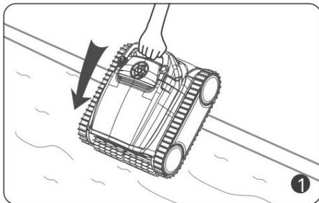
Greifen Sie den Griff des Staubsaugers und führen Sie ihn senkrecht in das Becken ein.
