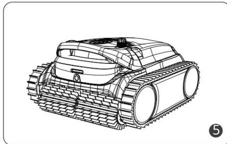
Nach dem Spülen den Filterkorb in den Staubsauger einsetzen und den Deckel schließen.
