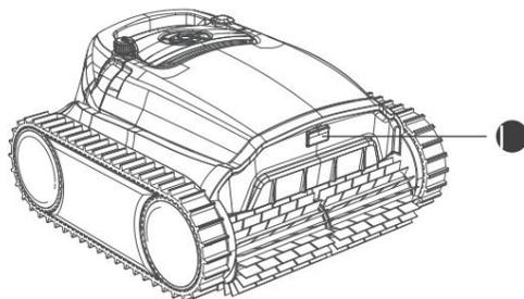
**J Deckelöffner-Taste** Öffnen Sie die Abdeckung und entnehmen Sie den Filterkorb
