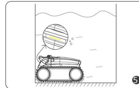
Das Gerät stoppt automatisch an der Wand, wenn die Reinigung abgeschlossen ist oder der Akku schwach ist.
