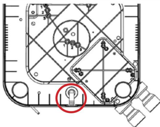
Orientace odvodu kondenzátu (při pohledu zespodu spotřebiče)
