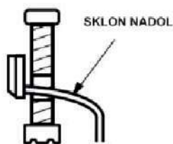
Korrekte Installation des Kondensationssschlauchs
