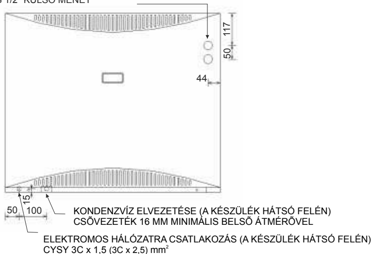
A MELEGVIZES FŰTŐTEST CSATLAKOZÁSA (HÁTSÓ PANEL) G 1/2" KÜLSŐ MENET
