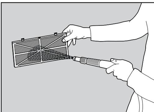
Reinigen Sie die Filter mit einem Wasserschlauch.
