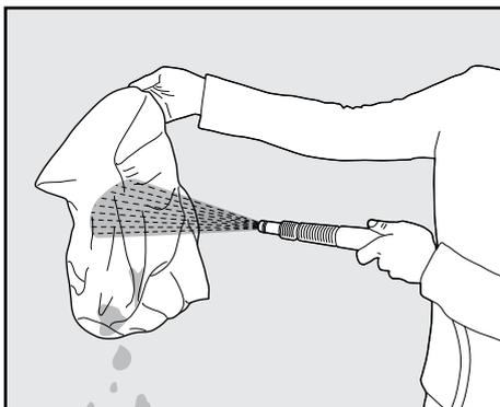
Reinigen Sie den Filterbeutel mit einem Wasserschlauch. Wir empfehlen, den Filterbeutel regelmäßig in der Waschmaschine unter Verwendung des Schonwaschgangs zu waschen. Reinigen Sie die Bürsten regelmäßig mit einem Wasserschlauch.
