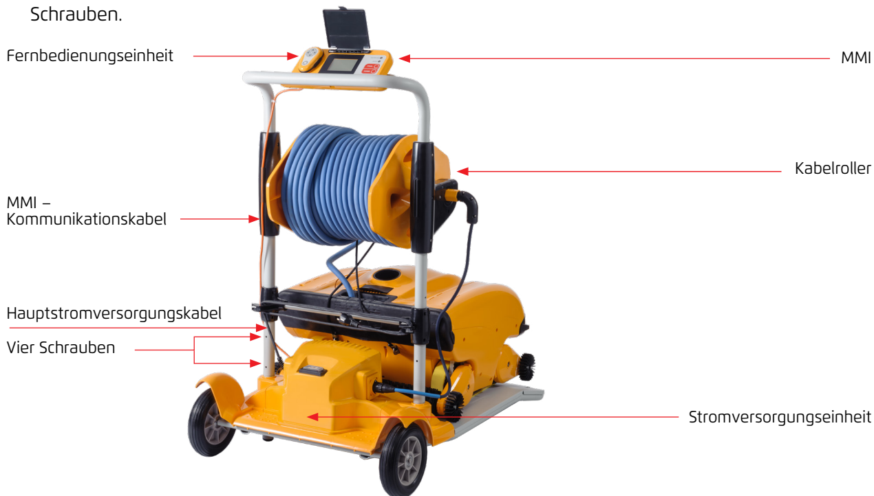
Abbildung 1: Zusammenbau des Dolphin WAVE 200 XL Schwimmbadreinigers - 1
