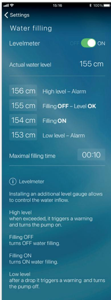
Der Wasserstand wird mittels Niveausensor gemessen. Dieser ermöglicht eine ganz einfache Installation durch Einsetzen des Sensors in den Ausgleichsbehälter oder Skimmer. Der Wasserstand wird in vier einstellbaren Stufen gesteuert, die einfach in Zentimeter eingestellt werden können.
