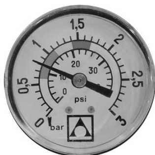
0,8 \text{ kg/cm}^2 - 11,4 PSI: Normaldruck bei Beginn des Filtriervorganges.
