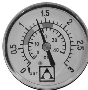
1,3 \text{ kg/cm}^2 - 18,5 PSI: Dieser Druck zeigt an, dass ein "SPÜLEN" notwendig ist.
