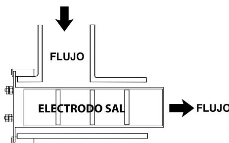
Para un correcto funcionamiento del vaso de electrólisis, se recomienda no situar el sistema de calentamiento a más de 20 m de la piscina (40 m de tubo ida/vuelta).
