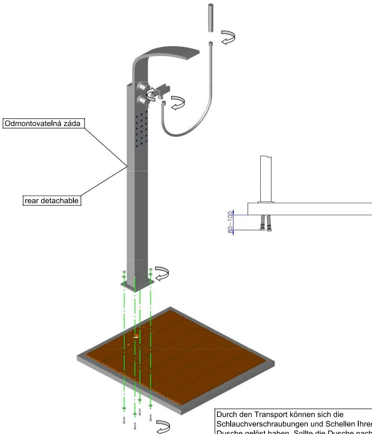
Během transportu se mohou povolít šrouby ve spojích. Pokud po prvotní instalaci voda vytéká, odšroubujte prosím záda a připevněte spoje.
