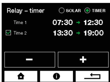
Um diese Funktion zu nutzen, wählen Sie im Menü "PROGRAMMIERBARES RELAIS" die Option "TIMER". Für die Aktivierung des Relais können ein oder zwei Intervalle eingestellt werden. Verbinden Sie das Zubehör, das vom TIMER gesteuert werden soll, mit dem potentialfreien Relais Timer / Heizung.
