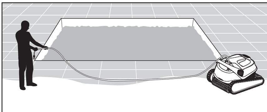
**5.1.2** Kabel abrollen und so ausziehen, dass es keine Knicke aufweist.
