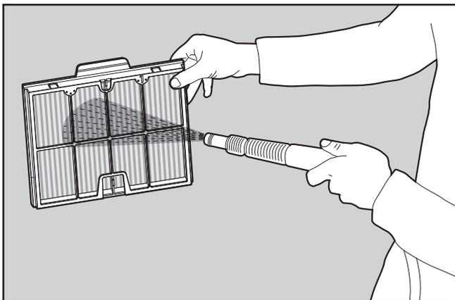
**6.2.4** Den Filter mit einem Schlauch reinigen.
